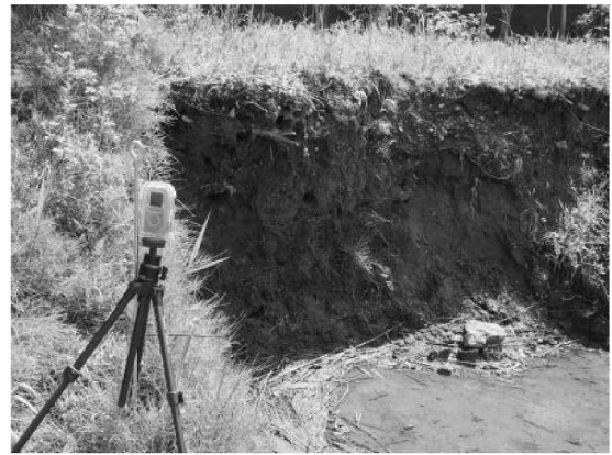
インターバルカメラの設置
