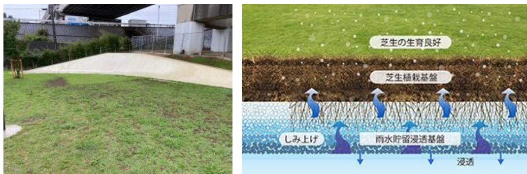
図3-21 芝生広場下の雨水貯留浸透基盤（環境空間戸田1緑地・緑道）
