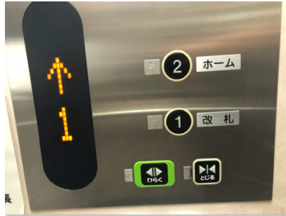
◎浮き出し文字のボタンは点字が読めない視覚障がい者でも認識できる
