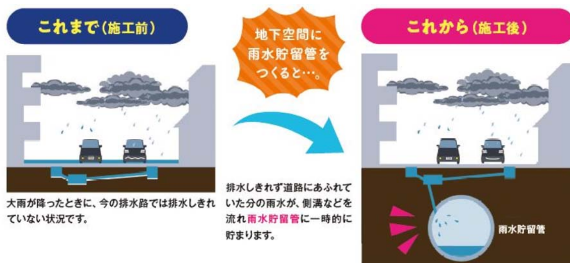
図3-12 雨水貯留管の整備イメージ
