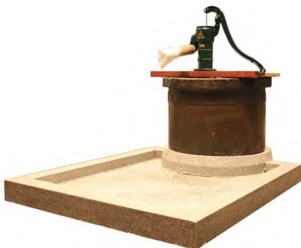
いど て お 井戸・手押しポンプ
