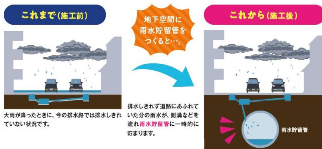
図3-12 雨水貯留管の整備イメージ
