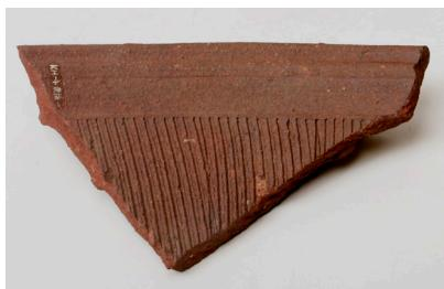
**炻器**：古墳時代の須恵器の系統を引く、高温で焼成される焼き物である。焼成温度はおよそ1250～1300度。陶器・磁器とは異なり、基本的に釉薬を使用しないことが特徴である。製品例としては、備前・明石・堺産の擂鉢、常滑の甕が挙げられ、近代にはテラコッタなども作られている。
