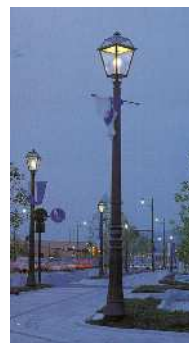
高演色ナトリウムランプ( 12) は色温度( 13) が低く、あたたかみがあります。
