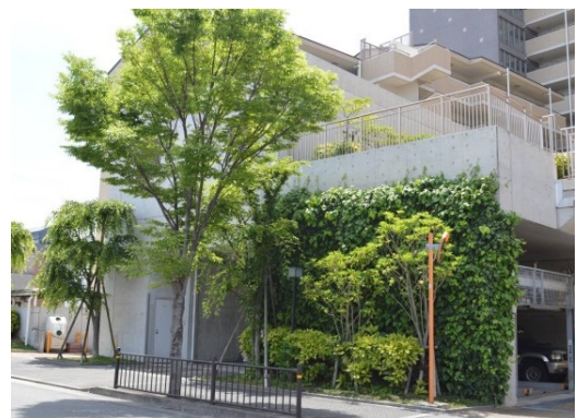
事例34 立体駐車場は壁面の分節化や低層部の仕上げ材の工夫、緑化修景等によって周辺の建物との違和感がないように気をつけている。
