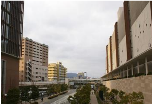
事例21 周囲の建物の外壁と意匠上の共通点を設けデザインイメージを合わせている。
