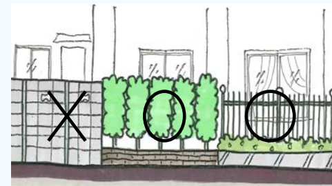
高いブロック塀よりも、低い塀や生垣、柵などの方が安全
